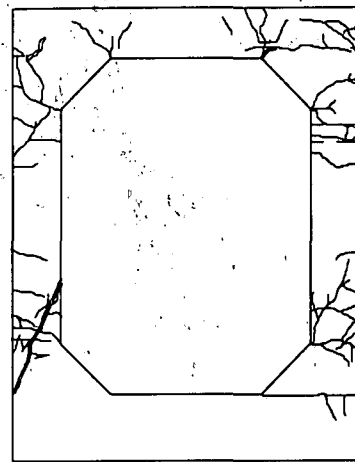
図-9 ひび割れ状況 (実験-3)
