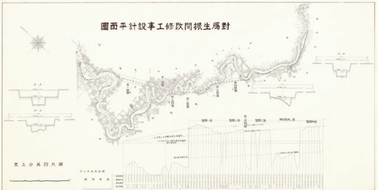
4. 設計変更された捷水路案(対雁(ついで)生振間改修工事設計平面図)
