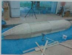
6. 型枠完成 やったー(´0´)ノ
