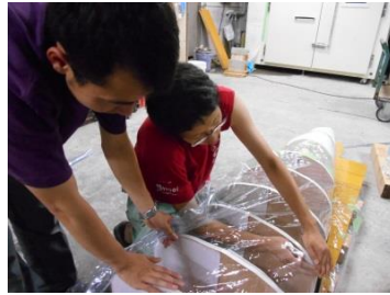
打設面のシートの設置
