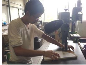
曲線部はコンターマシンでカット
