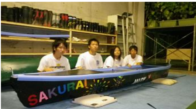
2年前に製作した3号機「Mark-X」細くシャープな船首部分は、水の抵抗と風の抵抗を受けないように絞り込んでありますが、直進性に欠けていました。
