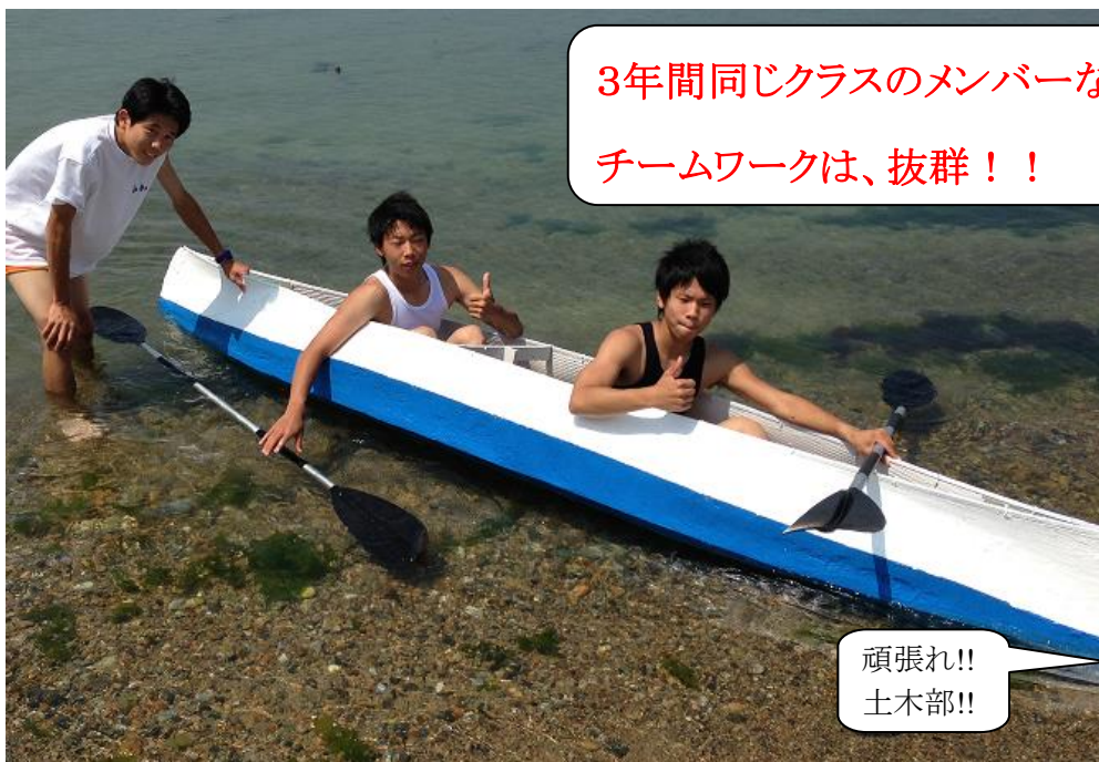
2年前に製作した3号機「Mark-X」細くシャープな船首部分は、水の抵抗と風の抵抗を受けないように絞り込んでありますが、直進性に欠けていました。
