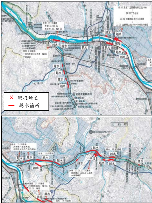
図-5 円山川(上図)と出石川(下図)における破堤、越水箇所 5)
