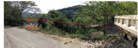
写真-12 随光川左岸における洪水痕跡
