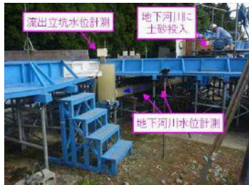
写真-7 流出立坑及び流出部実験
