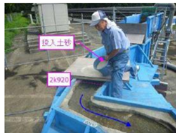
写真-5 河道からの土砂流入実験
