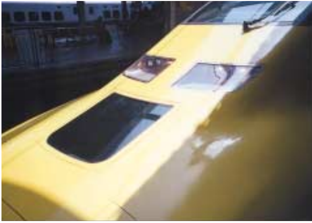
前方監視カメラ。カメラの方向や倍率は車内で操作できる。
