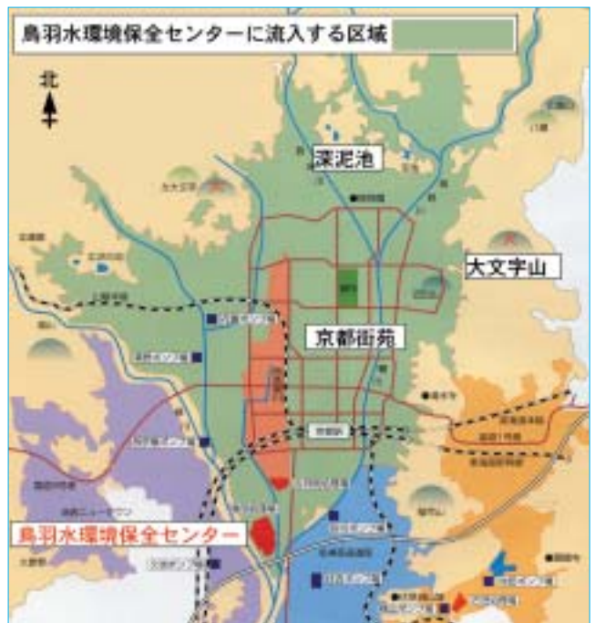
鳥羽水環境保全センターに流入する区域。京都市の下水整備は街の中心から外へと広がった。街の中心部は汚水と雨水を同一のパイプで排除する合流式下水道で整備されている。（京都市上下水道局パンフレットより）
