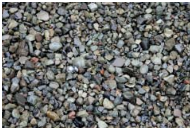
写真-9 汚泥を融解し、製造された小石。現在建設中の園路の舗装材としても使用されている
