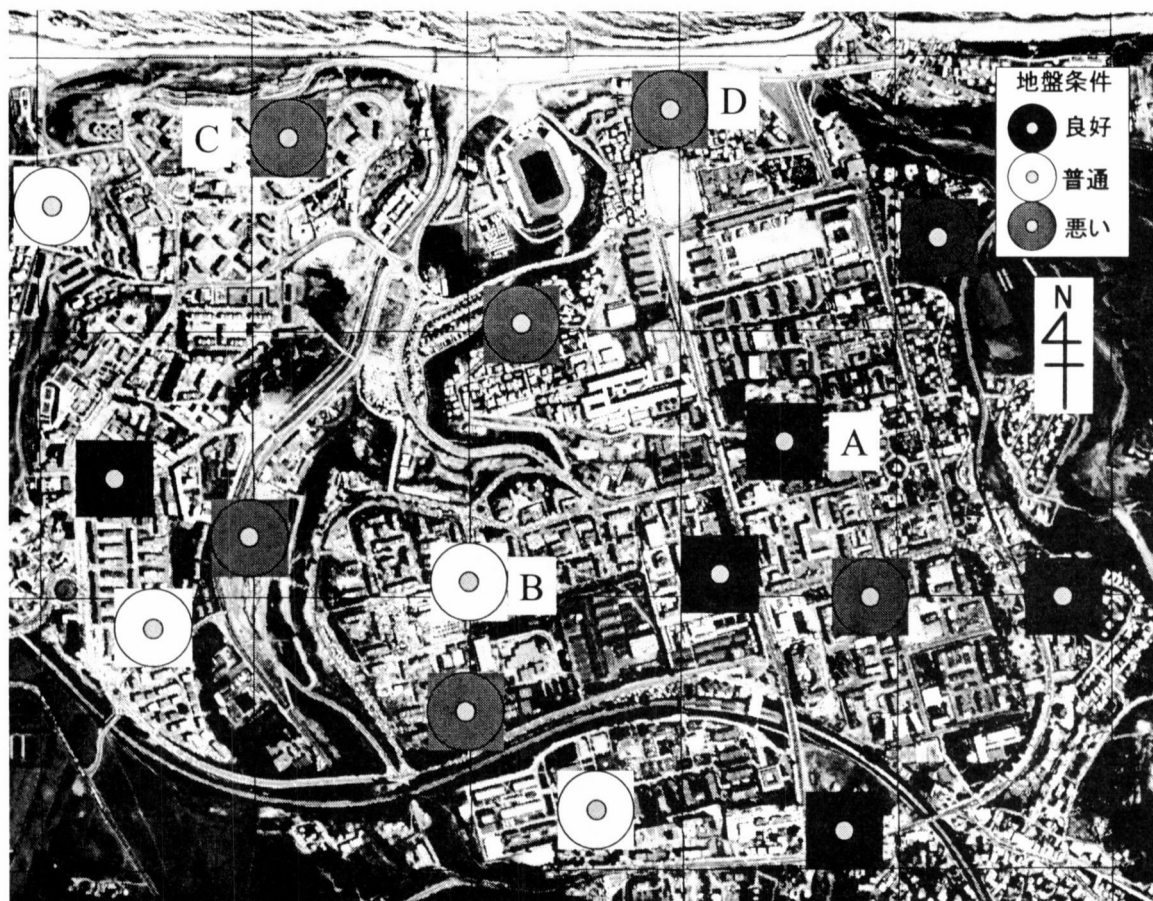
図4 常時微動計測による地盤条件の評価（水平動/上下動スペクトル比）
