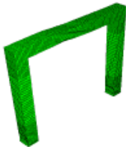
図3 3点ヒンジモデルの変形図
