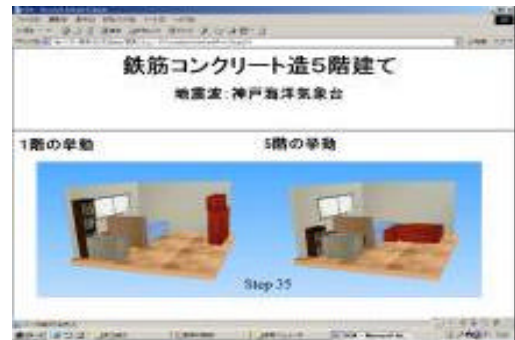
図7 家具の動的挙動のシミュレーション
