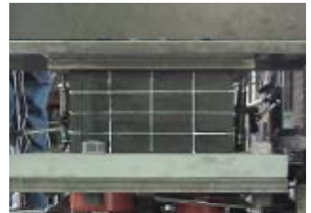
写真-2 ゴム支承
