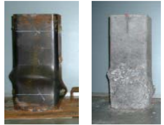
写真 - 1 破壊状況 (32HW - SC)
