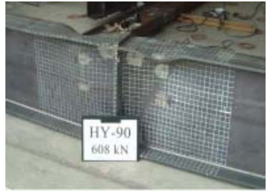
Photo.1 座屈後供試体
