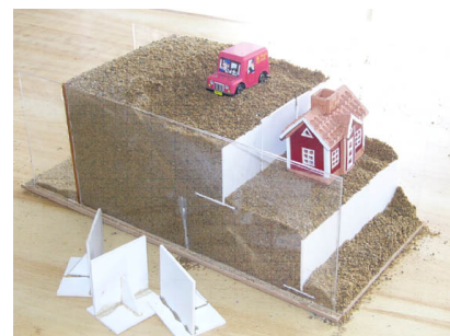
写真-15 L型擁壁の振動実験 3) （振動を加えても崩壊しない）
